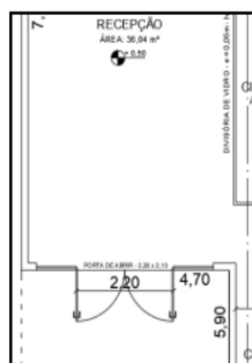
Imagem 02: Instalação Nova porta de abrir
